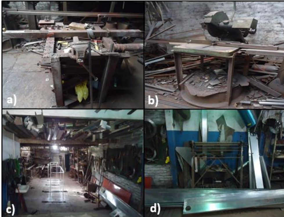
Figura 4 - Riscos de acidentes encontrados na empresa relacionados com a obstrução dos equipamentos: a) Torno; b) Máquina corta-ferro; c) Depósito de materiais no teto e paredes; d) Estocagem de material na parede (fora do depósito).
