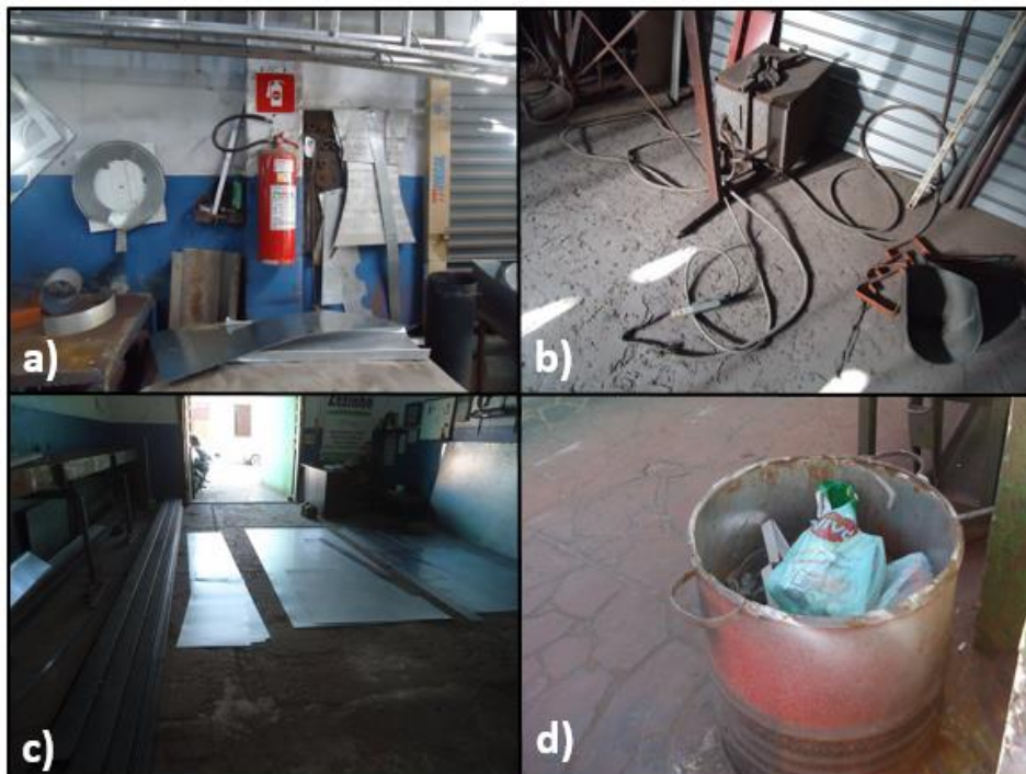
Figura 5 – Riscos de acidentes e irregularidades encontrados na empresa: a) Obstrução de EPCs; b) Mal uso de EPIs; c) Obstrução do corredor de saída; e d) Descarte incorreto de resíduos gerados.
